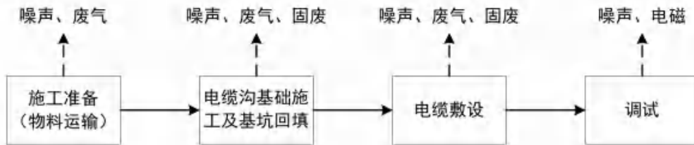
图2-6 电缆沟施工工艺及产污环节图
